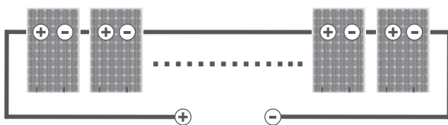
Reihenschaltung für mehr Spannung
