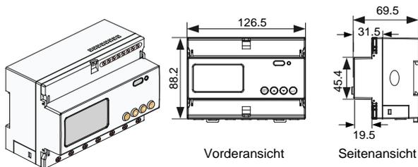
**Fig. 2-6** Dreiphasiger Smart Energy Meter – Abmessungen (Einheit: mm)
