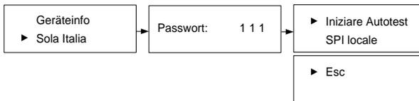
**Berühren Sie ENT**, um den automatischen Test zu starten. Falls sich der Wechselrichter im Status „Fehler“ oder „Abschalten“ befindet, kann der Test nicht gestartet werden und es wird eine Eingabeaufforderung angezeigt.
