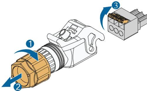
2. Führen Sie das AC-Kabel durch die Kabelverschraubung und das Gehäuse. Entfernen Sie auf einer Länge von weniger als 45 mm den Kabelaußenmantel und auf einer Länge von 12 mm–16 mm die Drahtisolierung.
