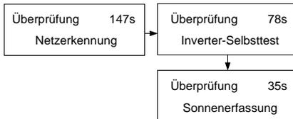
11. Nach erfolgreichem Abschluss der Prüfung wird bei ausreichender DC-Leistung mit der Einspeisung begonnen.
