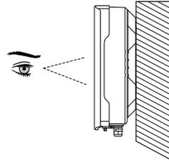
10. Installieren Sie ihn vertikal, um eine gute Wärmeabfuhr zu gewährleisten.
