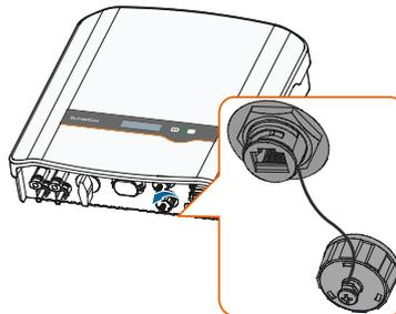
5. Drücken Sie den Meter-Adapter auf die Schnittstelle am Wechselrichter, bis er mit einem "Click" einrastet. Sichern Sie den Adapter mit der Mutter am Wechselrichter.
