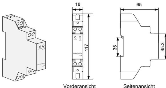
**Fig. 2-5** Einphasiger Smart Energy Meter – Abmessungen (Einheit: mm)
