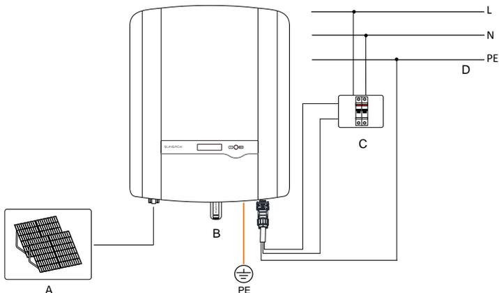
Fig. 5-1 Elektrisches Anschlussschema
