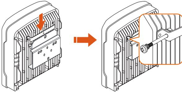
7. Um den Wechselrichter vor Diebstahl zu schützen, kann er mit einem Sicherheitsschloss gesichert werden. Das Sicherheitsschloss wird vom Benutzer gekauft, sofern eines erforderlich ist. Der Lochdurchmesser beträgt etwa 8 mm.
