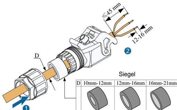
4. Führen Sie die entsprechenden Leiter in den Klemmblock. Verschließen anschließend Sie den Klemmblock.
