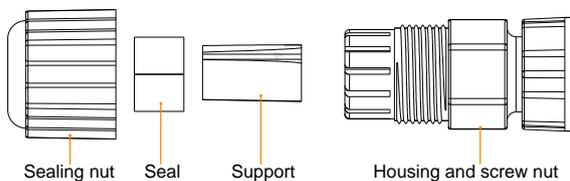
2. Führen Sie das Kommunikationskabel wie nachfolgend gezeigt durch den Adapter. Platzieren Sie den RJ45-Stecker so im Gehäuse, dass er vollständig darin verschwindet.
