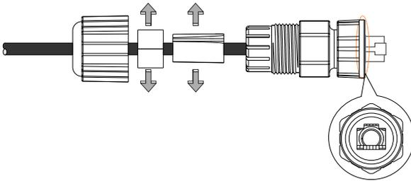
3. Drücken Sie die den Dichtring über das Kabel und verschließen Sie das Gehäuse des Adapters indem Sie die Verschraubung festziehen.
