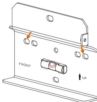
5. Bohren Sie die Löcher und bringen Sie die Wandhalterung an. Die Löcher sollten etwa 70 mm tief sein.
