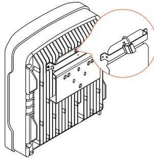
8. Entfernen Sie die wasserdichte Abdeckung vom RS485-Anschluss und bringen Sie das Kommunikationsmodul am Wechselrichter an. Die folgende Abbildung zeigt als Beispiel das Wi-Fi-Modul. Einzelheiten entnehmen Sie bitte der jeweiligen Anleitung.
