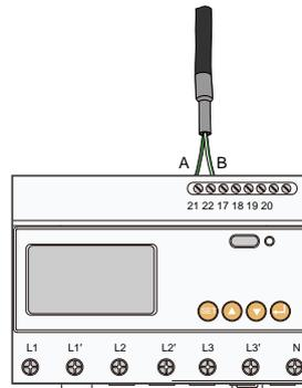
3. Entfernen Sie auf einer Länge von 10 mm die Isolierung der Stromkabel. Schließen Sie dann die Drähte an die Klemmen des Smart Energy Meter an (siehe unten). (Durchmesser: 10 mm<sup>2</sup> bis 25 mm<sup>2</sup>)
