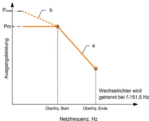
**Fig. 2-9** Wirkleistungsverhalten bei Überfrequenz
