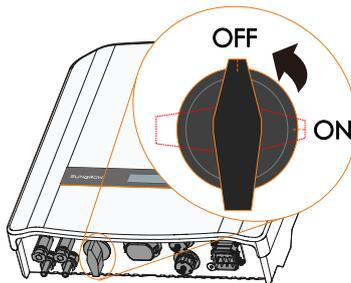
2. Überprüfen Sie das Anschlusskabel des PV-Strings auf die richtige Polarität und darauf dass die Leerlaufspannung die Wechselrichter-Eingangsgrenze von 600V nicht überschreitet, auch nicht bei der niedrigsten Betriebstemperatur. Detaillierte Informationen finden Sie in den vom Modulhersteller bereitgestellten Modulspezifikationen.
