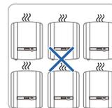
Für die Installation in mehreren Reihen muss der Abstand zwischen zwei Reihen mindestens 400 mm betragen.
