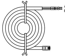
2. Schließen Sie die Stecker **A** und **B** an die Anschlüsse 21 und 22 am Smart Energy Meter an (siehe unten).
