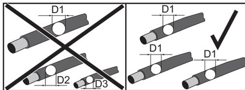
**HINWEIS!** Um eine effektive Zugentlastung der Solarmodul-Stränge zu gewährleisten, ausschließlich gleich große Kabelquerschnitte verwenden.
