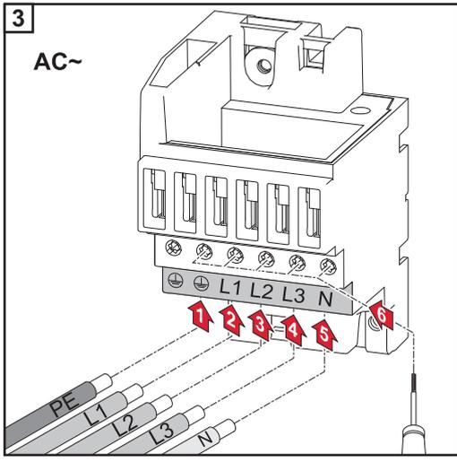
Werden AC-Kabel über die Welle des DC-Hauptschalters oder quer über den DC-Hauptschalter Anschlussblock verlegt, könnten diese beim Einschwenken des Wechselrichters beschädigt werden oder der Wechselrichter lässt sich nicht einschwenken.
