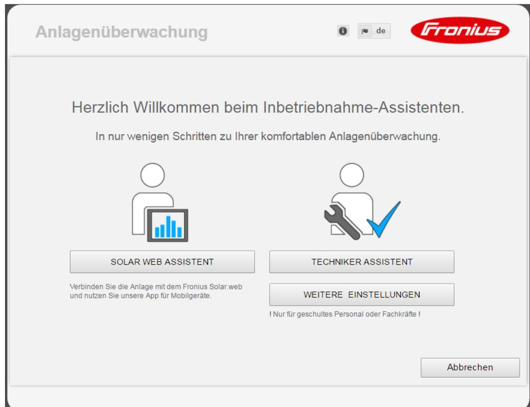
Wird der Techniker Assistent ausgeführt, unbedingt das vergebene Service-Passwort notieren. Dieses Service-Passwort ist für die Einstellung der Menüpunkte Anlagenübersicht, EVU-Editor und erweiterte Batterieeinstellungen erforderlich.
