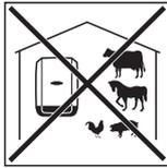
Den Wechselrichter nicht montieren in:
