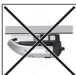
Den Wechselrichter nicht an der Decke montieren.
