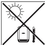
Um die Erwärmung des Wechselrichters so gering wie möglich zu halten, den Wechselrichter keiner direkten Sonneneinstrahlung aussetzen. Den Wechselrichter an einer geschützten Position montieren, z.B. im Bereich der Solarmodule, oder unter einem Dachvorsprung.
