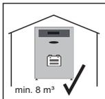
Die Batterie ist nur für die Montage im Innenbereich geeignet. Um das Auftreten eines explosionskritischen Gemisches im Fehlerfall zu verhindern, muss die Batterie in einem Raum mit mindestens 8 m<sup>3</sup> Raumvolumen aufgestellt werden.
