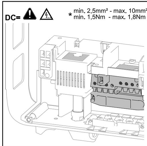
max. Kabelquerschnitt pro DC Kabel: 10 mm<sup>2</sup>
