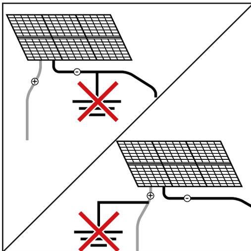
Der Hybrid-Wechselrichter ist ein trafoloses Gerät. Die einzelnen Pole der Solarmodule dürfen nicht geerdet werden.
