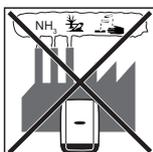
Den Wechselrichter nicht montieren:
