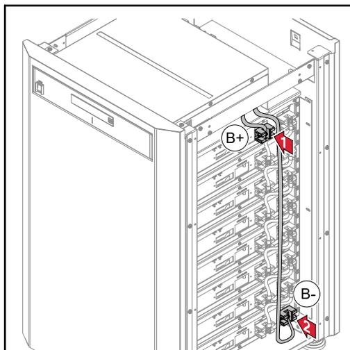
**1** Spannung zwischen  $U_{B-}$  und  $U_{B+}$  überprüfen
