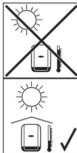
Um die Erwärmung des Wechselrichters so gering wie möglich zu halten, den Wechselrichter keiner direkten Sonneneinstrahlung aussetzen. Idealerweise den Wechselrichter an einer geschützten Position montieren, z.B. im Bereich der Solarmodule, oder unter einem Dachvorsprung.
