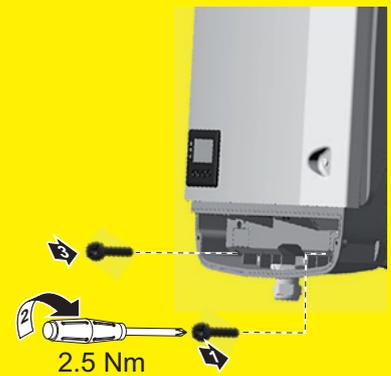
Den Wechselrichter immer mittels Fixierungsschrauben mit dem in der Bedienungsanleitung angegebenen Drehmoment fest an der Wandhalterung verschrauben. Wechselrichter ausschließlich mit festgezogenen Fixierungsschrauben in Betrieb nehmen!
