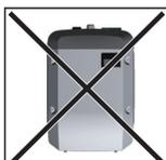
Den Wechselrichter nicht mit den Anschlüssen nach oben an einer senkrechten Wand oder Säule montieren.
