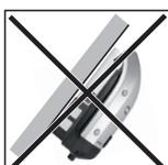
Den Wechselrichter nicht überhängend mit den Anschlüssen nach unten montieren.
