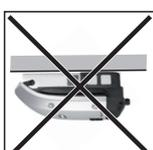
Den Wechselrichter nicht an der Decke montieren.
