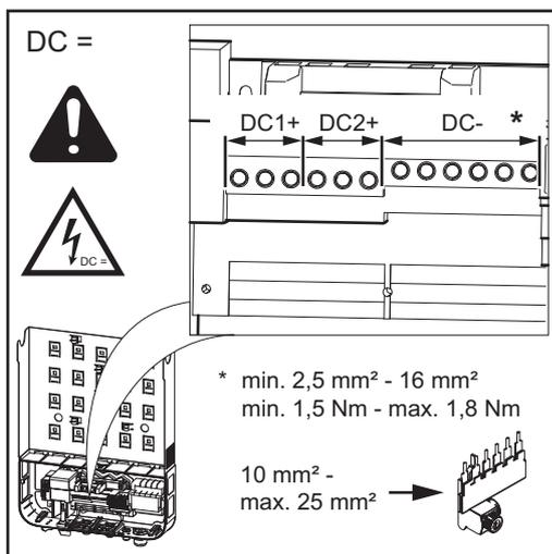
max. Kabelquerschnitt pro DC Kabel: 16 mm<sup>2</sup>
