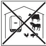
Den Wechselrichter nicht montieren in:
