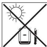
Um die Erwärmung des Wechselrichters so gering wie möglich zu halten, den Wechselrichter keiner direkten Sonneneinstrahlung aussetzen. Idealerweise den Wechselrichter an einer geschützten Position montieren, z.B. im Bereich der Solarmodule, oder unter einem Dachvorsprung.
