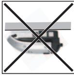
Den Wechselrichter nicht an der Decke montieren.
