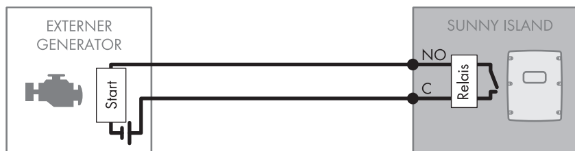
Abbildung 11: Anschluss der Generatorsteuerung an den Sunny Island
