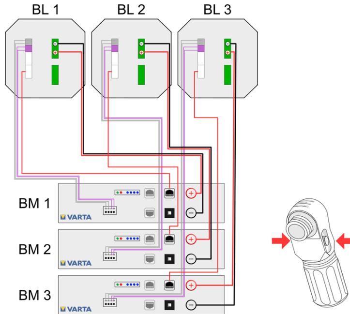
Abbildung 8: Batterielader 1 und 2, Batteriemodul 1, 2 und 3,
