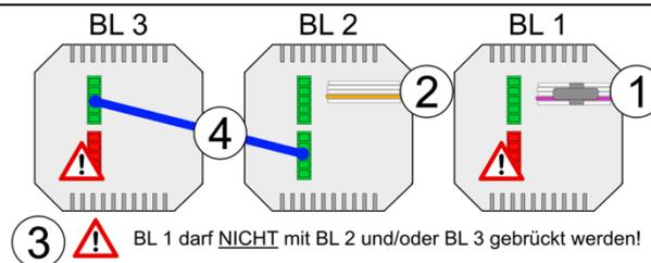
Abbildung 16: Batterielader 1, 2 und 3 Rückseite
