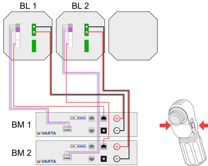
Abbildung 6: Batterielader 1 und 2, Batteriemodul 1 und 2
