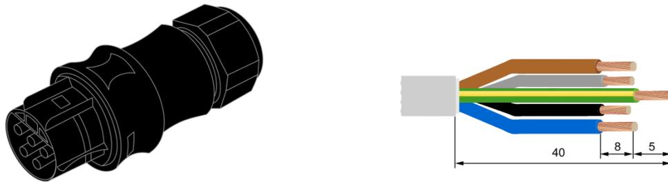
Für den Netzanschluss muss die 5-adrige Netzanschlussleitung an die mitgelieferte Steckverbindung (schwarzer Stecker) angeschlossen werden
