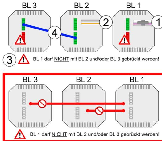
Abbildung 9: Batterielader 1, 2 und 3 Rückseite
