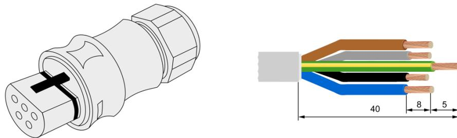
Für den Ersatzstromanschluss muss die 5-adrige Ersatzstromanschlussleitung an die mitgelieferte Steckverbindung (lichtgrauer Stecker) angeschlossen werden.
