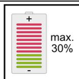
Die Batteriemodule sollen einen **Ladezustand von 20 bis 30 %** ihrer Kapazität haben. Laden oder entladen Sie gegebenenfalls die Batteriemodule.
