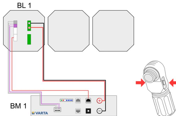
Abbildung 4: Batterielader 1 - Batteriemodul 1
